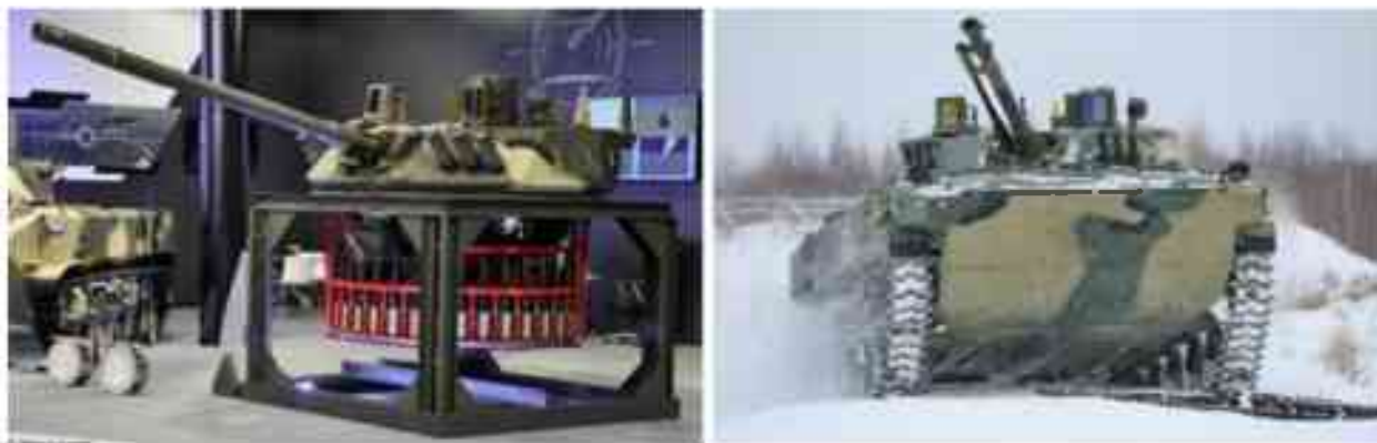
Рисунок 1 – Боевой модуль «Бахча-У» установленный на БМД-4 (РФ)
