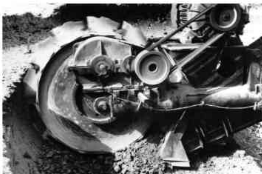
Рисунок 5 – Работа экскаватора с одним рядом прямых ножей на роторе нижней разгрузки
